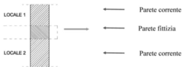
32. ponte termico è la discontinuità di isolamento termico che si può verificare in corrispondenza agli innesti di elementi strutturali (solai e pareti verticali o pareti verticali tra loro);
