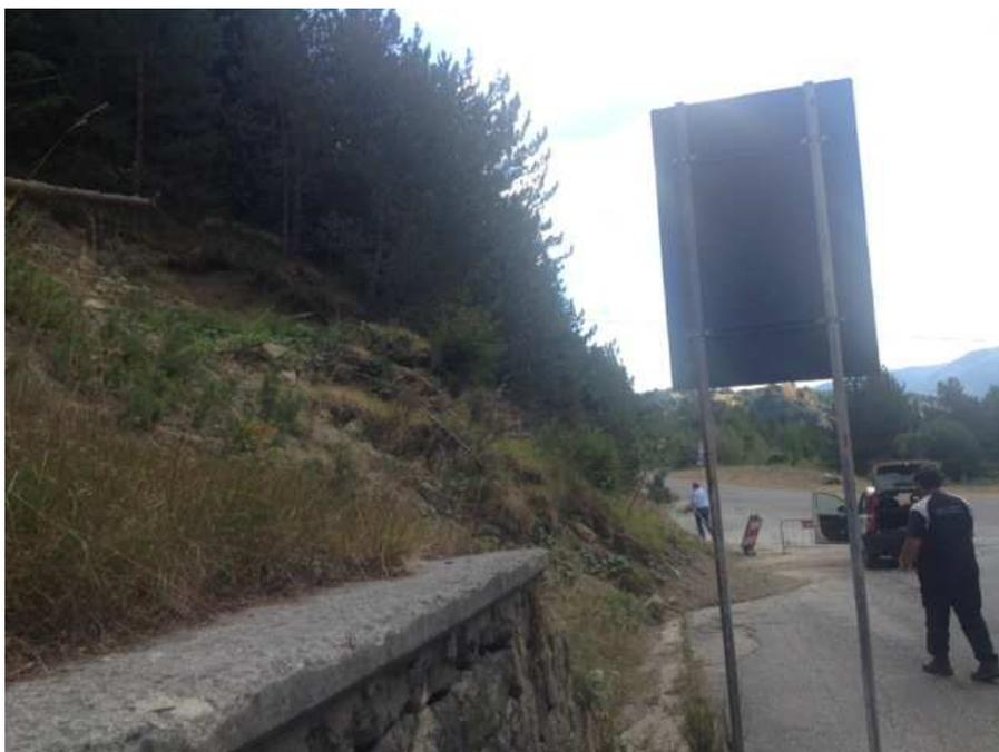
Il movimento franoso, classificabile in uno scorrimento-rotazionale (slides) ha interessato la coltre di copertura di natura eluvio colluviale che sovrasta le marne stratificate di base e soggiace la porzione sommitale di versante, costituita da arenarie stratificate molto fratturate.
